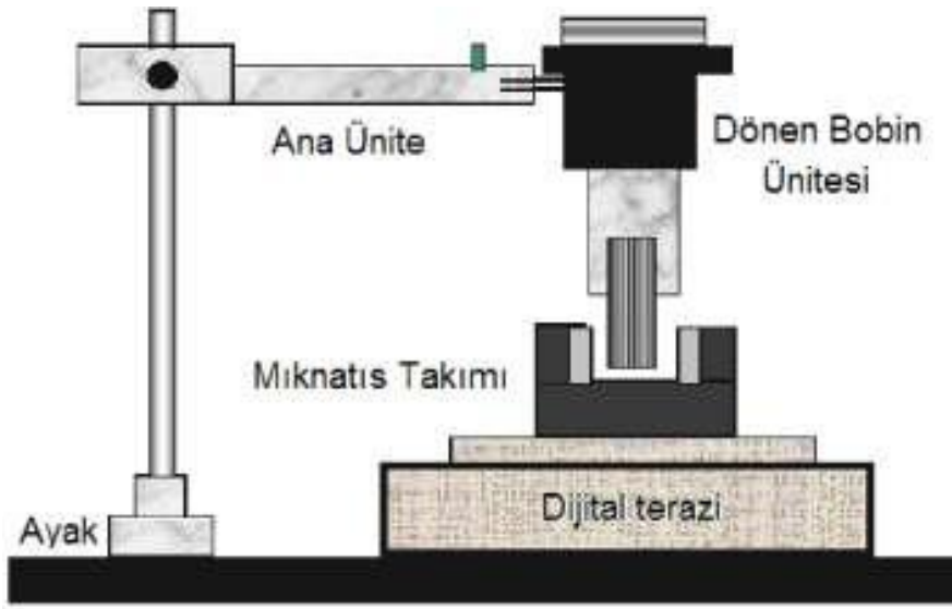
Şekil 5. Akım terazisinin kurulumu (bobin için)
