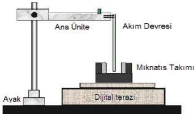
Şekil 3. Akım terazisinin kurulumu (tel için)
