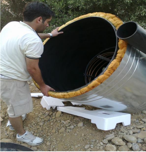
Güneş Havuzunun Yalıtımlı Tankı-Güneş Enerjisi Araştırma Sahası Çukurova Üniversitesi Kampusü-Adana
