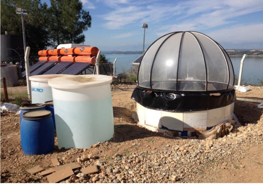
Yeni Model Su Damıtma Sisteminin Kurulması- Çukurova niversitesi Kampus-Adana
