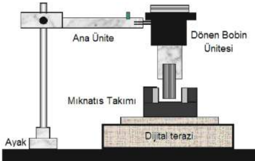
Şekil 5. Akım terazisinin kurulumu (bobin için).
