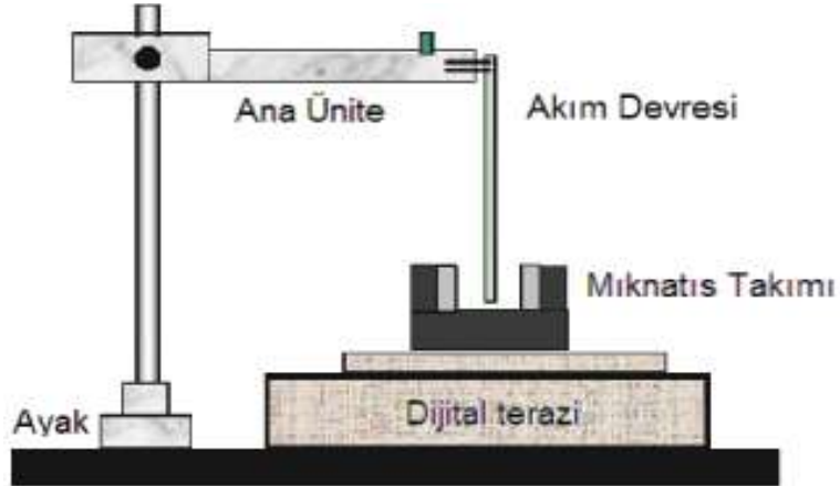
Şekil 3. Akım terazisinin kurulumu (tel için).
